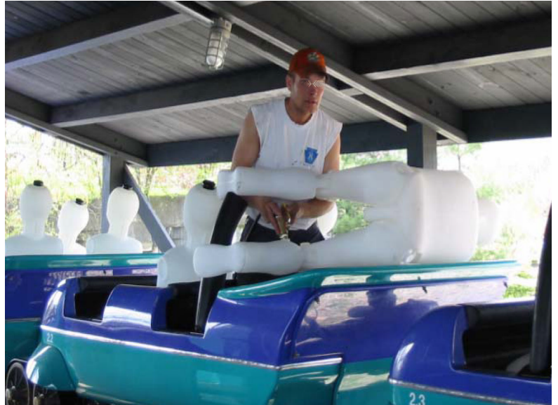
Seitlich drehen, um die Wade zu befüllen, was von einer Seite getan werden kann, so dass nicht umgedreht werden muss.
