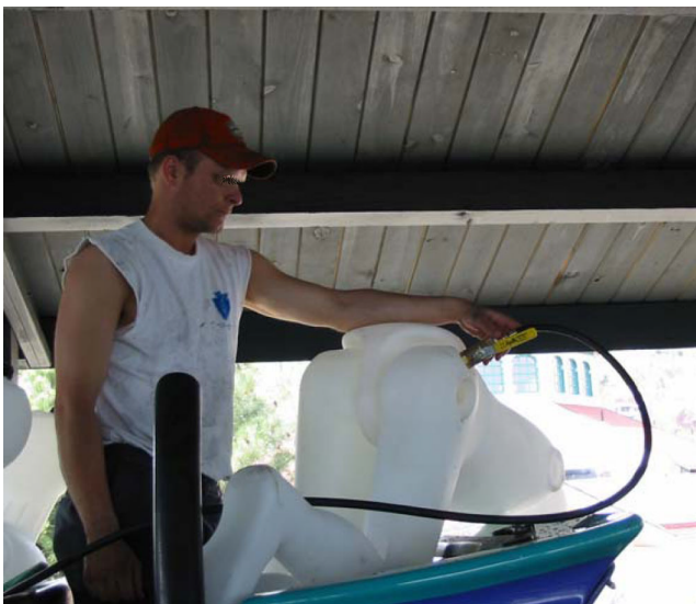
Rumpf- und Kopfteil füllen, wenn der Manikin im Fahrsitz sitzt. Festen Verschluss der Stutzen überprüfen. Wir empfehlen das Verschließen der Stutzen unter Verwendung von Zange oder Schraubenschlüssel, besonders bei der Hüfte, so dass sie nicht am Sicherheitsbügel reiben.
